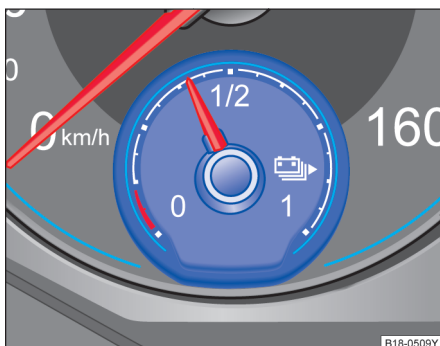
图 110 在组合仪表盘上：高压蓄电池的电量表和备用电量区域。
